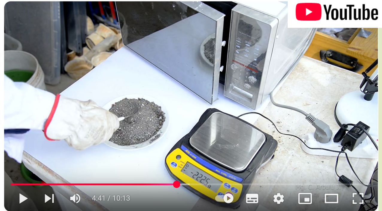
Humedad de suelo con horno microondas - ASTM D 4643
